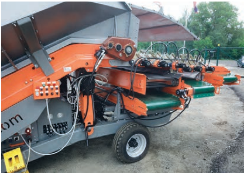
С гидравлическим приводом и функцией скоростной очистки вальцов
