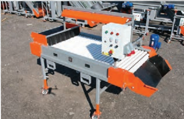
Специально разработанный стол уменьшенных размеров шириной рабочей зоны 900 мм и длиной 2000 мм
