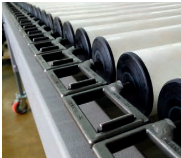
Роликовый стол длиной 4,5 м и шириной рабочей поверхности 1,5 м
