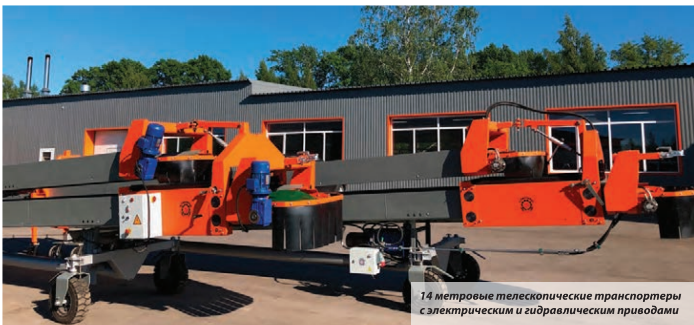
17 метровый телескопический транспортер с электрическим приводом
