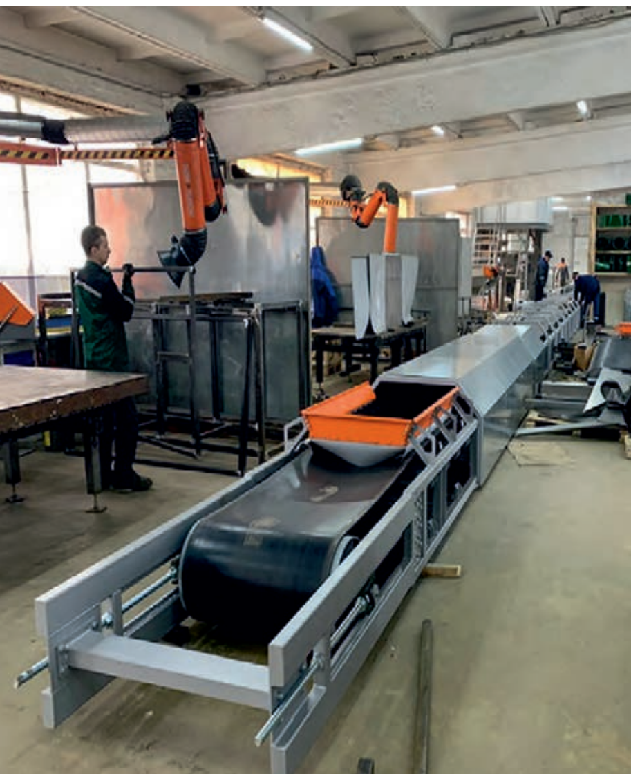
60 метровый транспортер с шириной ленты 800 мм для перемещения до 70 тонн картофеля в час из одного здания в другое в морозостойком исполнении
